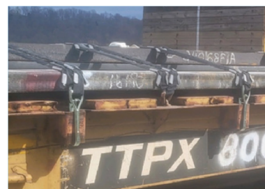
Exemple de placement acceptable du crochet en J sur la face extérieure en raison de la conception du wagon
