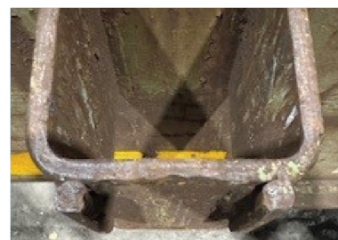
Exemple de Stake Pocket qui nécessite de placer le crochet en J du côté droit ou gauche
