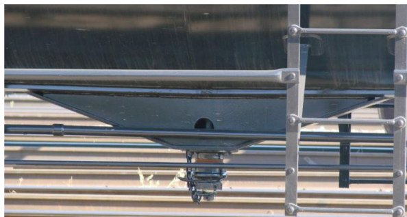
Robinet de vidange par le bas, dispositif ventral de protection—vue externe
