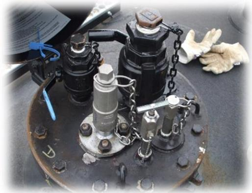
Les *trous d'homme* sont une ouverture dans le haut du wagon; un couvercle à 6 ou 8 boulons, selon le modèle, permet de pénétrer dans le wagon-citerne. Deux styles de joint d'étanchéité statiques sont utilisés pour former le joint final. Le couvercle du trou d'homme est parfois muni **d'un dispositif casse-vide**, qui laisse entrer de l'air dans la citerne pour en éviter l'implosion.
